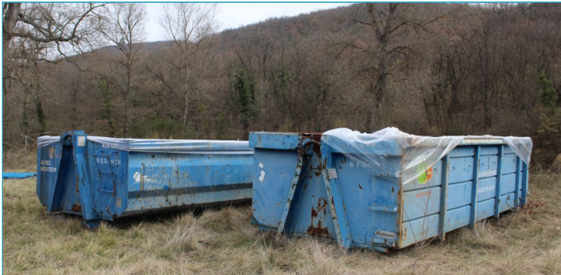
Figure 5 : Bennes de décantation
